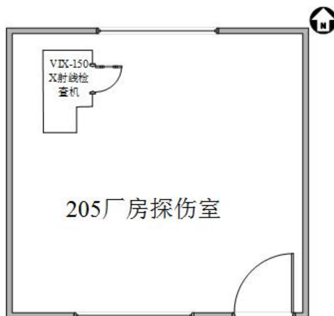
图 2 辐射工作场所平面布置图
