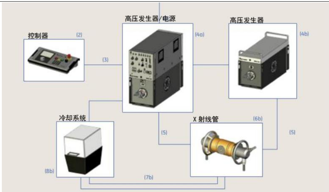
图 9.2 工业 X 射线探伤机设备组成示意图
